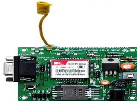
Fig.7.2. GSM Module
