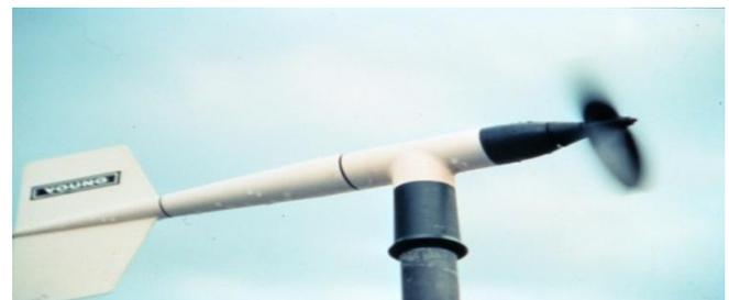
Fig. 3.Vane Anemometer
