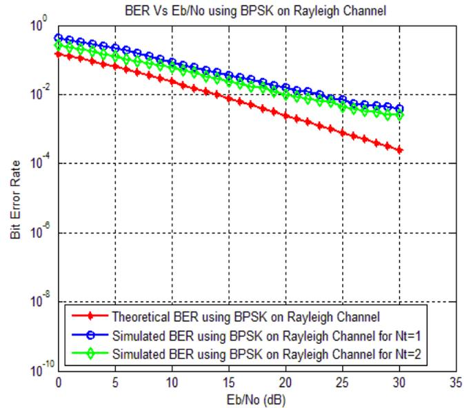
Fig. 5 BER VS ED/NO FOR BPSK
