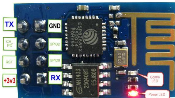
Fig 4 ESP8266 Module
