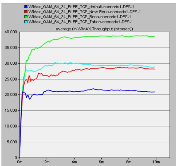
Fig. 9 QAM 64\_34 BLER throughput
