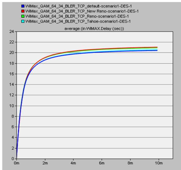
Fig. 5 Average QAM 64\_34 BLER delay
