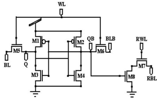
Fig. f. 8T SRAM Cell
