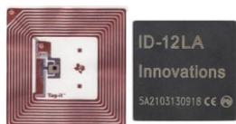
Fig.2 (a)RFID tag Fig. 2 (b) RFID reader IC
