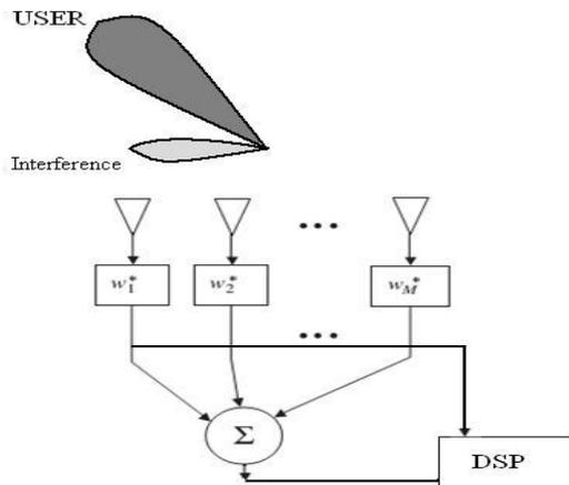
Fig. 1M-Element Smart Antenna
