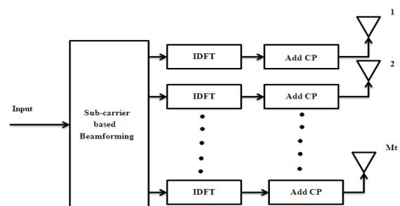
Fig. 1. Transmit Beamforming
