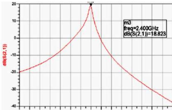
Figure 12: LNA Forward Voltage Gain 18.82 dB (S21)
