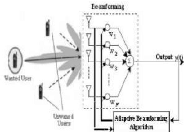
**Fig. 1. Smart Antenna System.**
