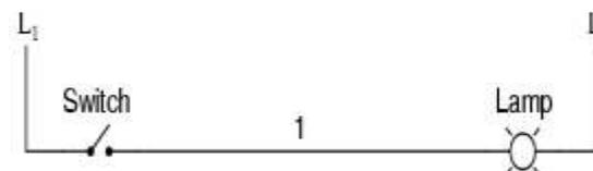
FIGURE 2: LADDER LOGIC RUNG EXPLANATION 1 [5]
